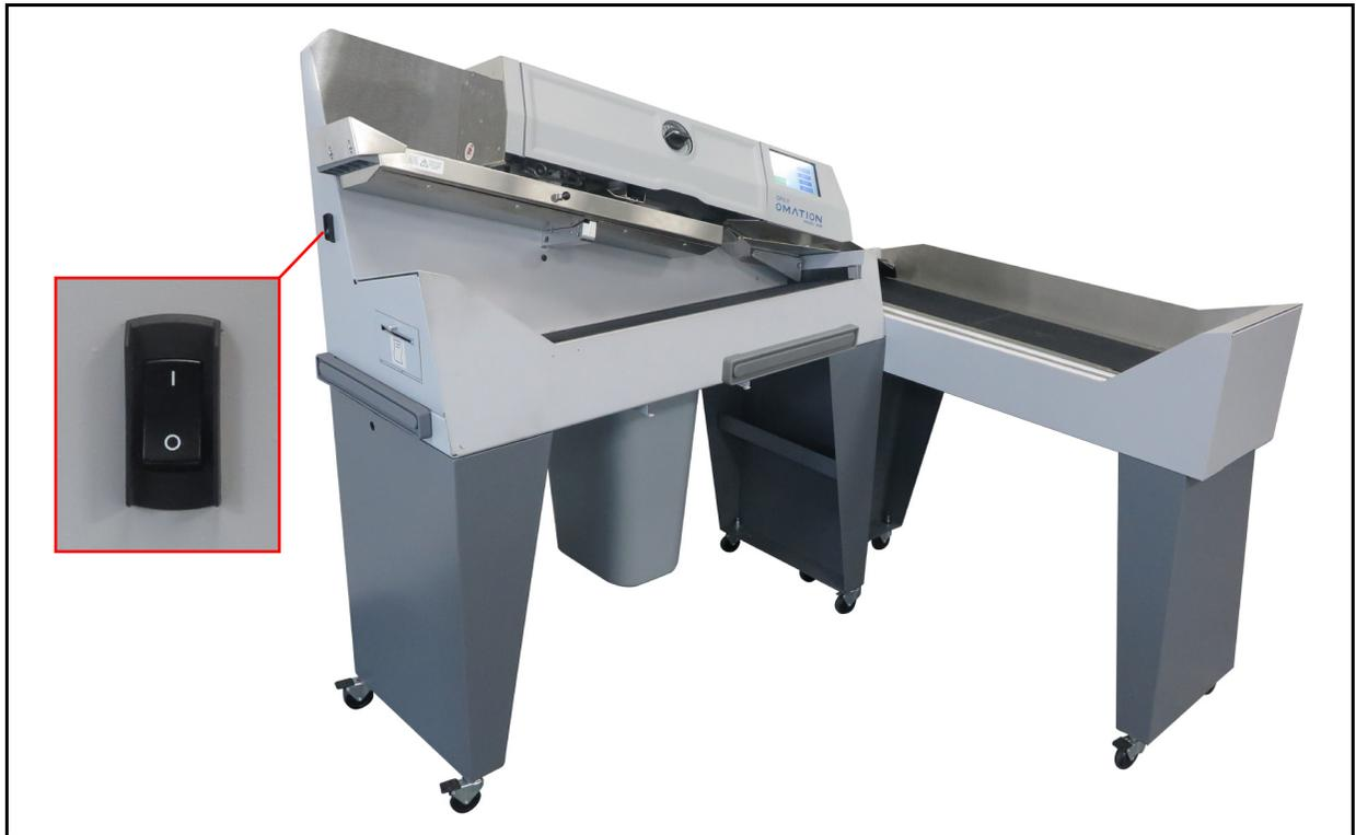
**Abbildung 7-1: Netzschalter Modell 606**
