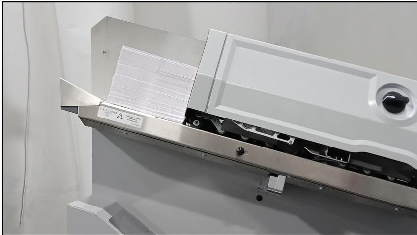
**Abbildung 5-6: Post im Einzug positioniert**
